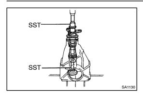
(d) Using SST and a press, install the companion flange. SST 09223-46011, 09325-40010
