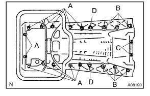
(d) Tighten 20 bolts and 2 nuts.
