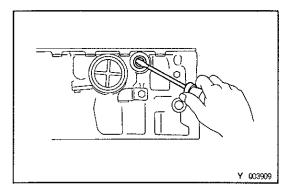
(d) Using a screwdriver, remove the oil seal.
