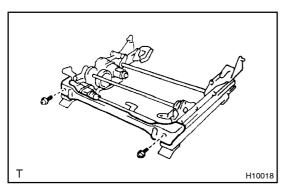
6. **INSTALL FRONT POWER ADJUSTER SHIELD**
